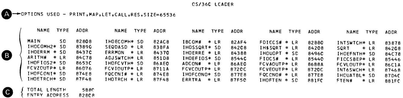
Figure II-9. Loader Output
