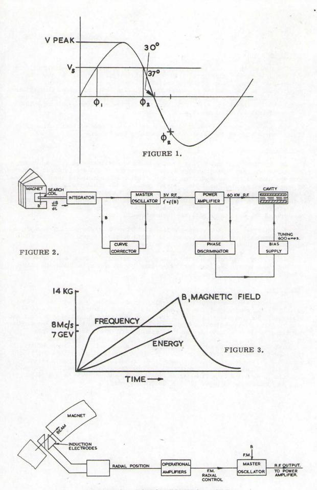
FIGURE 4. RADIAL CONTROL LOOP
